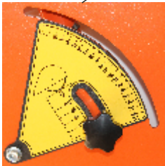
Posibilitatea de a regla grila de indicare a adancimii, in functie de dimensiunea discului montat
